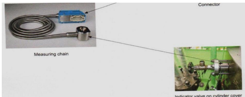
Hình 7: Phản hồi áp suất xilanh qua indicator valve.
