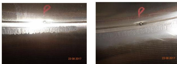
Hình 2. Hình ảnh của sơ mi xi lanh trước và sau khi mài
