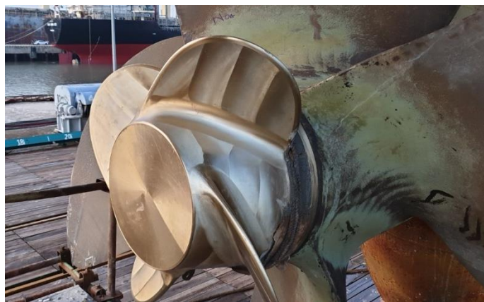
Hình 1. Chân vịt phụ lắp cho tàu Fortune Navigator [4]
